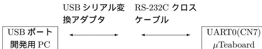
図 1.3 USB シリアル変換による接続
