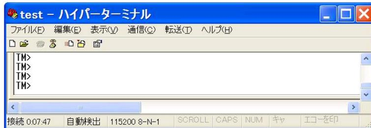
図 1.5 端末ソフト上に表示された T-Monitor のプロンプト
