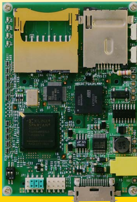
μT-Engine/ARM7-LH79532開発キットのCPUボード(原寸大)
