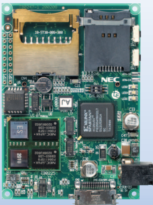
μT-Engine/Vr4131開発キットのCPUボード（原寸大）
