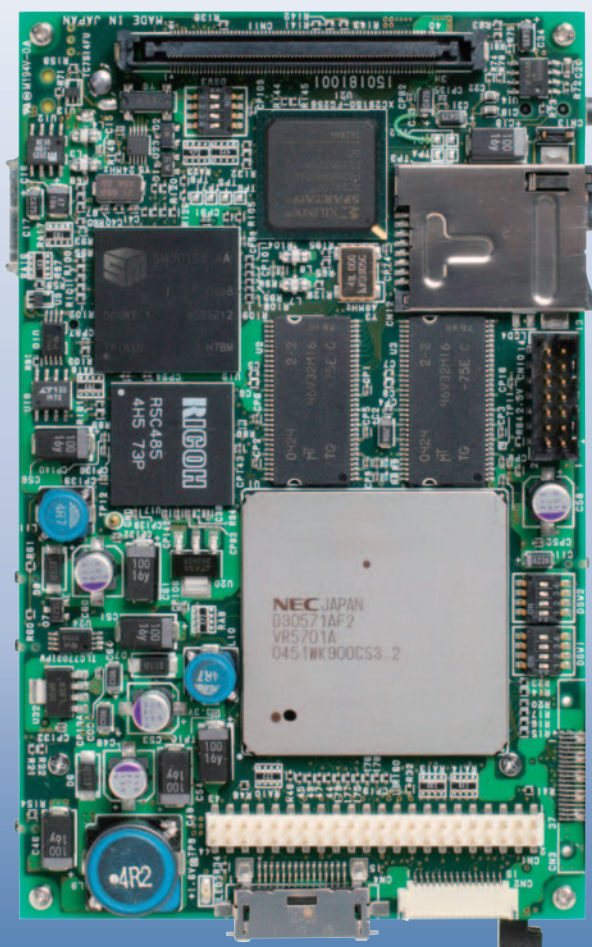
T-Engine/VR5701 開発キットのCPUボード(原寸大)
